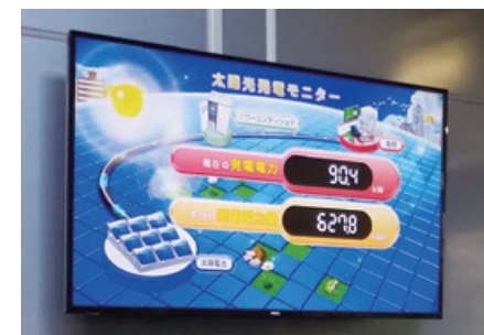
事務所棟玄関にて発電量が確認できます
