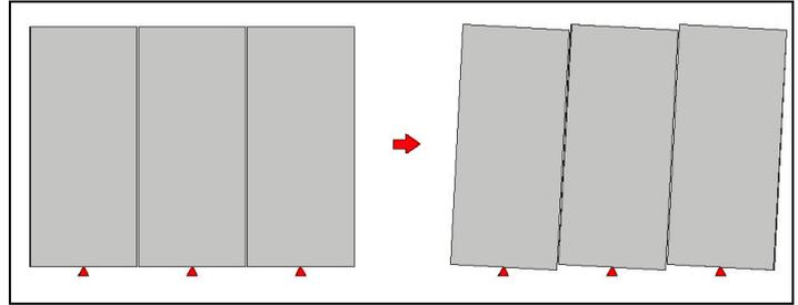
$1/100\text{rad}$  では、900mm 幅パネルの上昇と下降がそれぞれ約 4.5mm であり、パネルと下地の隙間、高層クリップのルーズホール内ボルトの移動ともに余裕があります。
