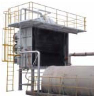
また、本装置は、薬品を一切使用しないことからランニングコストも低く、回収した蒸気は、ボイラー水などに再利用が可能です。さらに、設備面積も小さく、メンテナンスも容易に行なうことができます。
